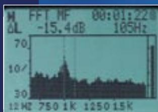
▶ Analisi spettrale per banda fine (opzione FFT).
