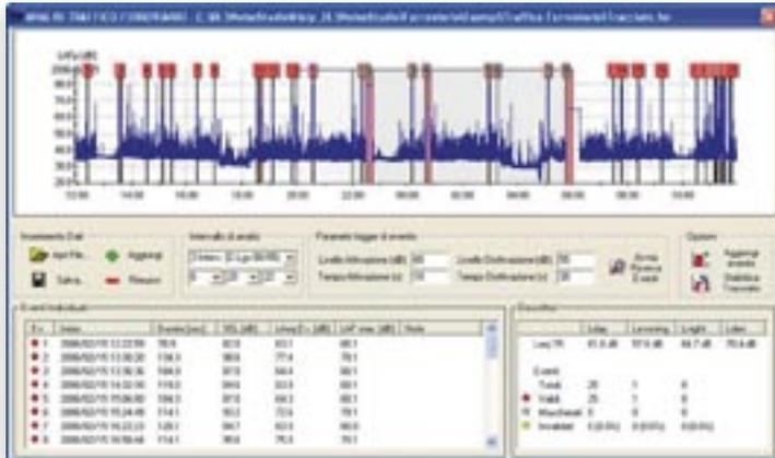
**DL5 Noise Studio:** Modulo Traffico Ferroviario: analisi sulle 24 ore con ricerca automatica dei transiti.
